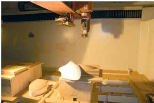
**Progettiamo e realizziamo internamente gli impianti di stampaggio per le nostre produzioni in serie grazie ad un centro di lavoro di ultimissima generazione a 5 assi in continua computerizzato con dimensioni massime di blocco lavorabile di 4.000 x 1.800 x 800 mm, partendo dal polistirolo espanso fino ad arrivare all'alluminio.**
